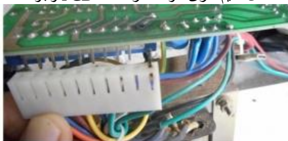
یک اتصال لحیم کاری سوخته در قسمت PCB وجود داشت.
